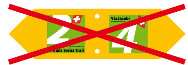
Abb. 27 Auf einem doppelspitzigen Wegweiser nie zwei verschiedene Routenfelder anbringen!
